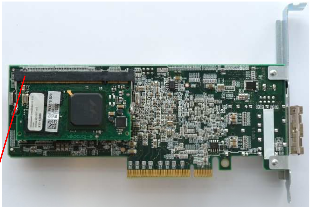
CPUボード搭載用コネクタ(Optional) Colibri SODIMM sized computer moduleに対応
